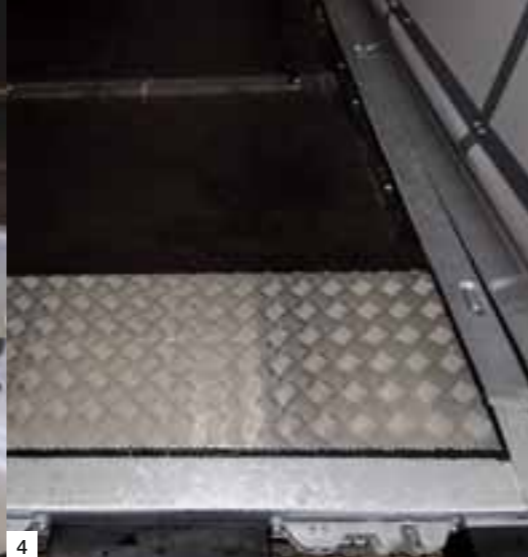
4 Verschleißblech am Bodenende minimiert Bodenschäden bei ruppiger Beladung.
