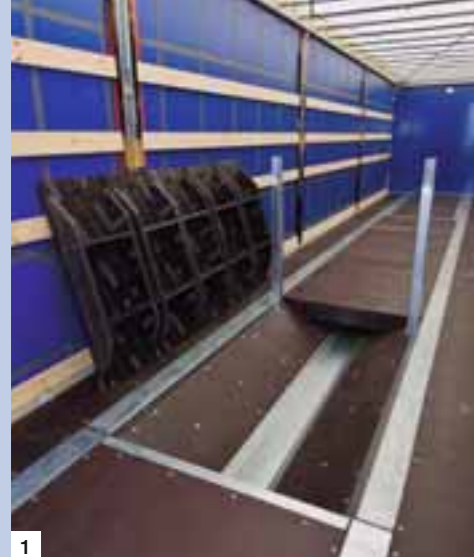
1 S.CS COIL mit VARIOS® TopTechnology: Eine spezielle vollverzinkte Mulde und Stahlungen bieten sicheren Halt für Stahlcoils im Schwerlastverkehr. Mit den Coilmuldenabdeckungen kann die Mulde für den Einsatz bei Normaltransporten geschlossen werden.
