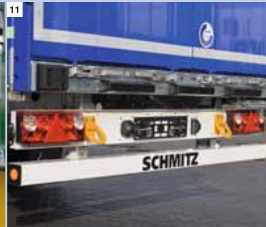
11 Nachrüstbare, geschraubte Ferry-Ringe für den sicheren Seetransport.
