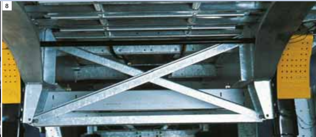
8 Bei den bewährten feuerverzinkten Chassis werden alle Komponenten bereits vor dem Bolzen verzinkt.
