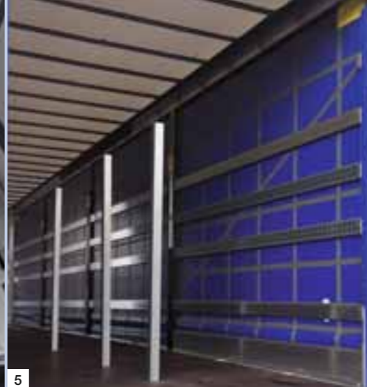
5 8 Paar Zusatzrungen, einsteckbar in mittig/außen liegenden Rungentaschen für noch mehr Ladungssicherheit.
