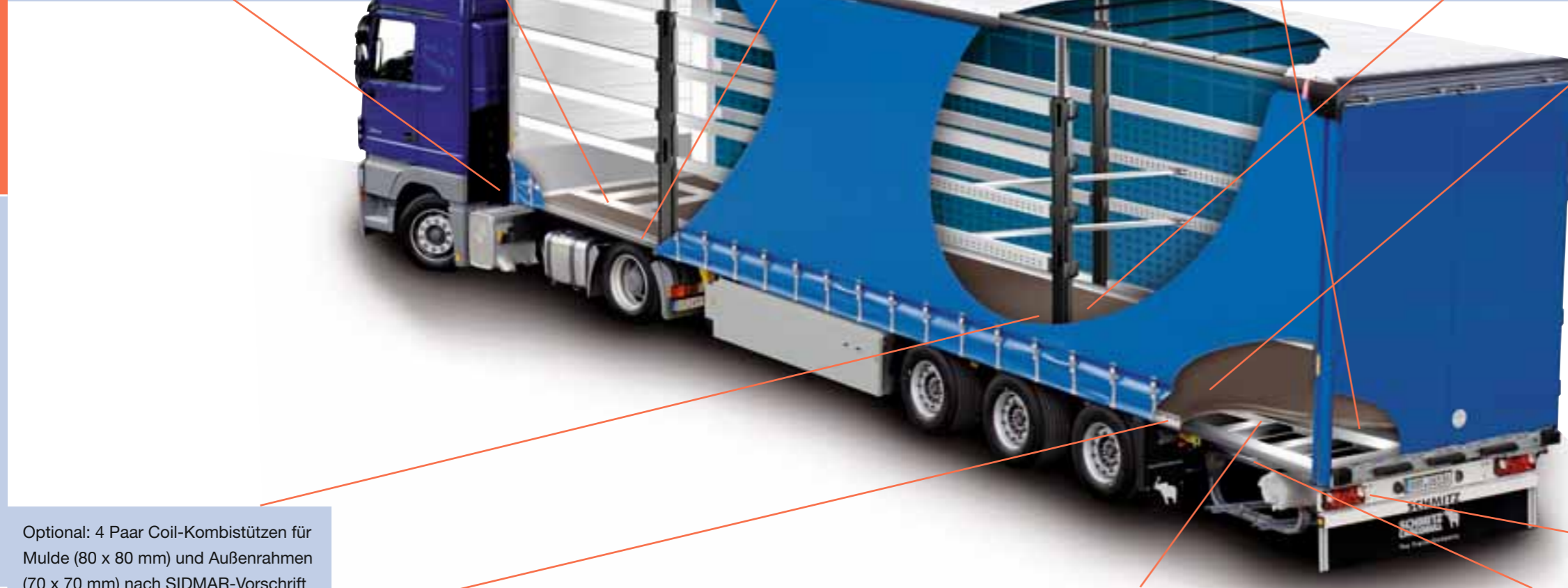
8 Bei den bewährten feuerverzinkten Chassis werden alle Komponenten bereits vor dem Bolzen verzinkt.
