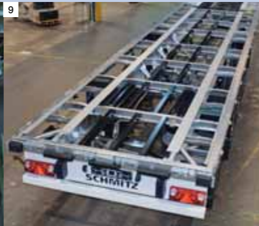
9 Chassis-konstruktion für Staplerachslast von 7,1 t.
