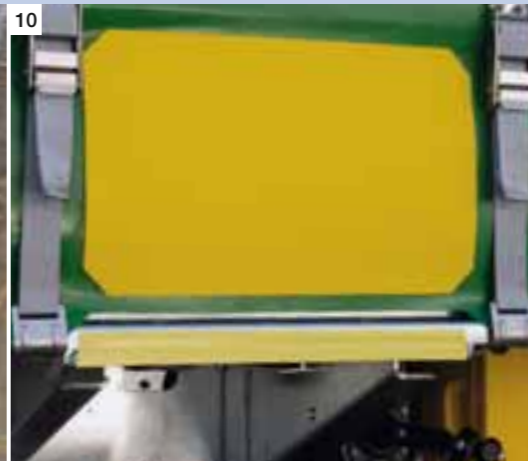
10 Gebolzte Griffleisten für den kombinierten Verkehr, Huckepackausstattung nachrüstbar.
