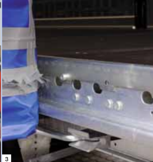
3 Durchgehende Zurrlochung im Außenrahmen sowie geschraubte Palettenanschlagleisten bieten vielfältige Sicherungsmöglichkeiten.
