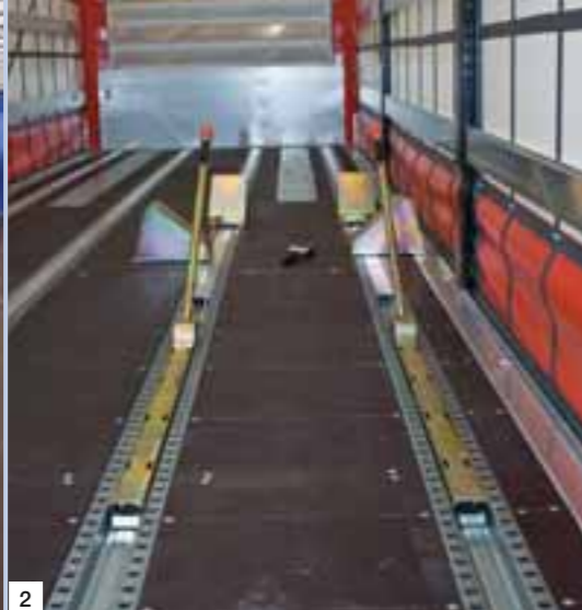
2 Durchgängige Stahlschienen für den Jolodroller mit Lochraaster für Sicherungскеilen bieten optimale Ladungssicherung.
