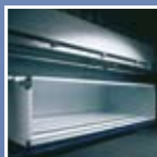
Verzinkter Palettenkasten für den Platz sparenden Transport von bis zu 34 Europaletten
