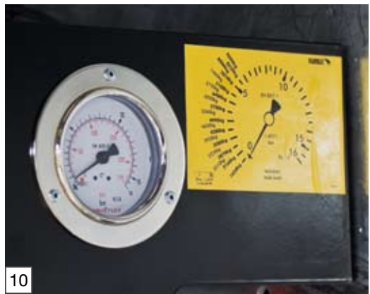
Anzeige zur Kontrolle der Achslasten
