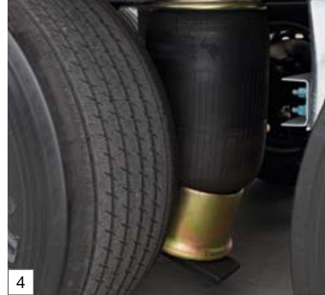
MRH-Luftfederung mit 350 mm Ø Luftball und Stahlkolben
