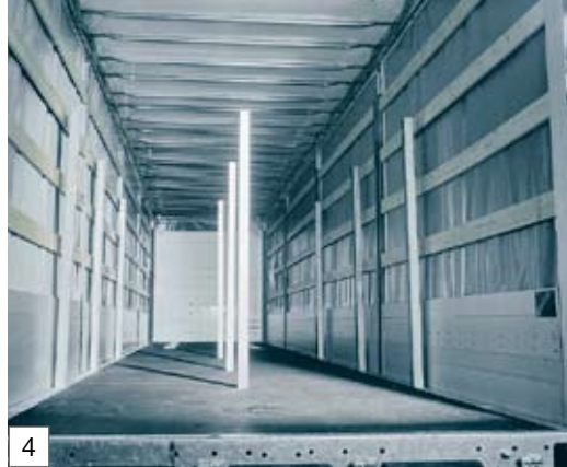
Acht Paar Zusatzrungen einsteckbar in mittig/außen liegenden Rungentaschen
