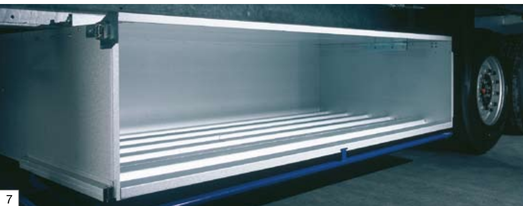
Verzinkter Paletten-Kasten für 24, 30, 32 oder 34 Paletten
