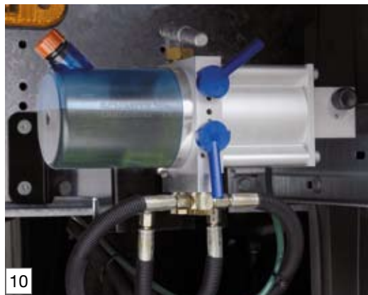
Hydropneumatische Pumpe zum bequemen Liften des Daches – links, rechts und beidseitig
