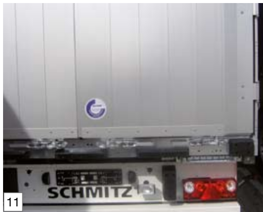
Glatte Alu-Tür, vier innenliegende Drehstangen-Verschlüsse und Monogelenk-Scharnier
