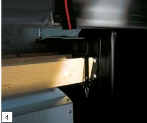
Halterung für Aufsatzlatten seitlich am Langträger
