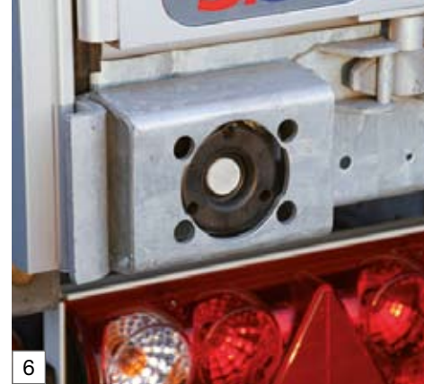
Elektronische Rampen-Anfahrhilfe mit akustischem und optischem Signal
