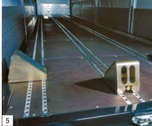
Vier Paar Lochschiene im Boden mit Ladungssicherungskeilen
