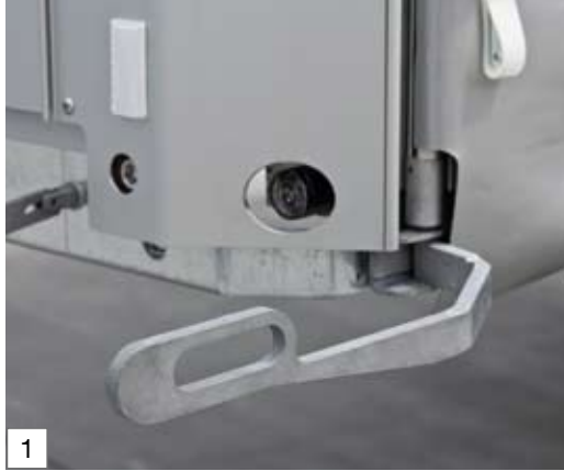
Vordere Entspanneinrichtung für schnelles Öffnen und Schließen der Seitenplanen
