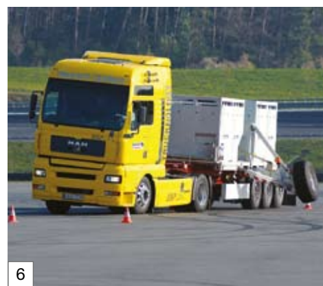
Sicherheit in jeder Lage – das integrierte elektronische Stabilitätsprogramm RSP sorgt durch rechtzeitigen Bremsengriff für eine sichere Kurvenlage auch in kritischen Situationen
