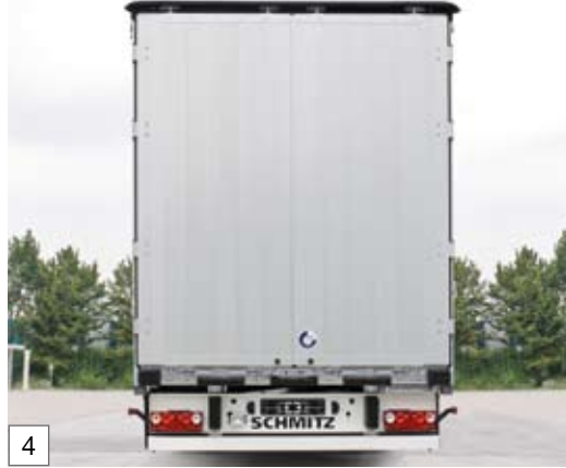
Hohe Rückwandtür zur schnellen, heckseitigen Be- und Entladung
