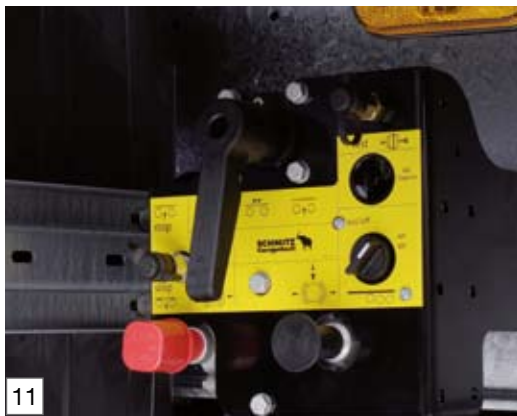
Komplette Druckluft-Bedieneinheit mit AUTO-RESET vermindert Balgschäden
