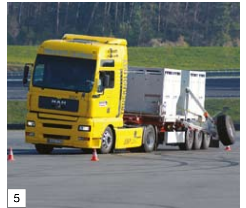
Sicherheit in jeder Lage – das integrierte elektronische Stabilitätsprogramm RSP sorgt durch rechtzeitigen Bremsengriff für eine sichere Kurvenlage auch in kritischen Situationen
