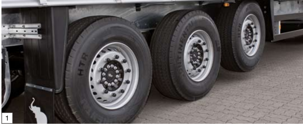
Achslift an der ersten Achse für automatisches Heben und Senken
