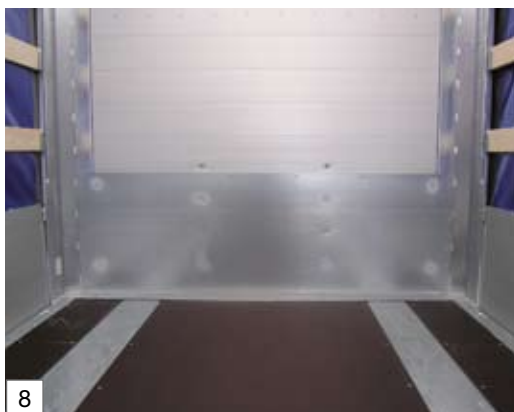
Stahl-Rammschutz schützt die Alu-Stirnwand bei rauer Beladung – nach EN 12642 XL geprüfte Sicherheit
