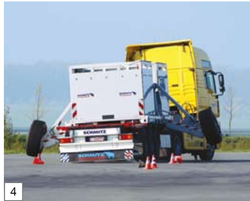
Sicherheit in jeder Lage – das integrierte elektronische Stabilitätsprogramm RSP sorgt durch rechtzeitigen Bremsengriff für eine sichere Kurvenlage auch in kritischen Situationen
