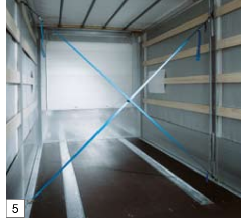
Diagonalgurte zur Verminderung von Aufbau- bewegungen bei Teilbeladung
