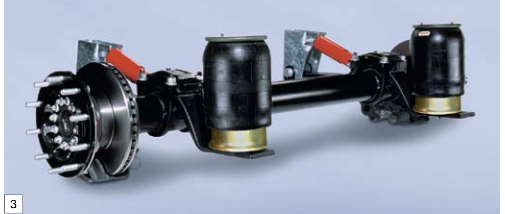
ROTOS® Fahrwerk mit großer innenbelüfteter 22,5" Scheibenbremse
