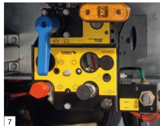
Komplette Druckluft-Bedieneinheit mit AUTO-RESET-Funktion vermindert Balgschäden
