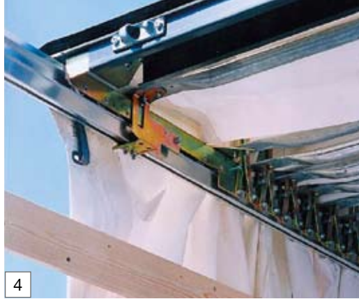
Schiebedach mit nach vorn verschiebbaren Endspiegeln für freie Kranbeladung
