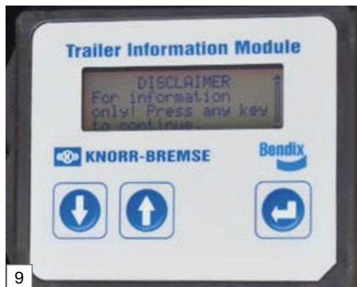
Trailer-Informationssystem zur Anzeige von Fahrzeugdaten, wie z. B. Achslast, Bremsbelagverschleiß und Laufleistung
