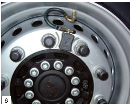
Reifendruck-Kontrollsystem erhöht die Laufleistung und reduziert Reifenschäden
