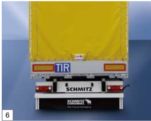
Rückwand mit Plane und hoher Rückwandtür zum schnellen, heckseitigen Be- und Entladen
