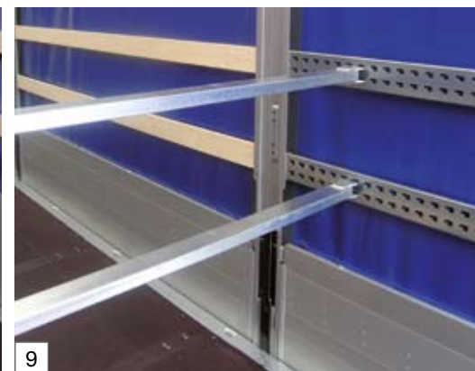
Flexible Sicherungsbalken für einen sicheren Stand bei Teilbeladung
