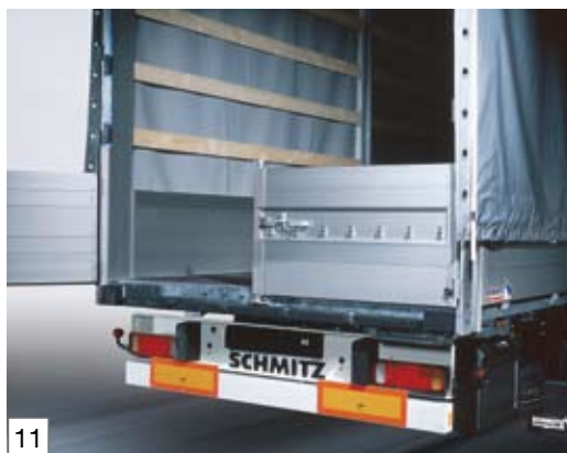
720mm hohe Doppelflügeltür mit innenliegendem Drehstangen-Verschluss
