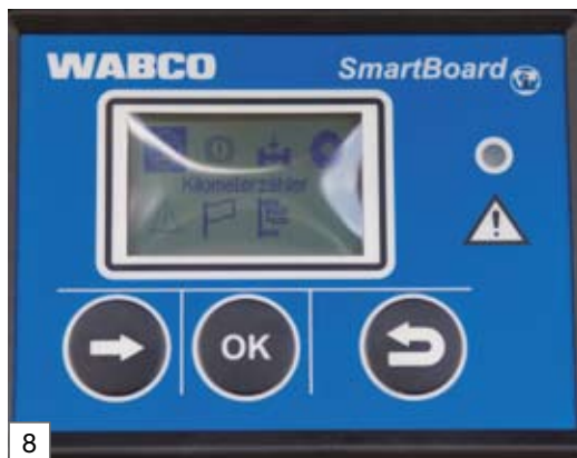
Trailer-Informationssystem zur Anzeige von Fahrzeugdaten, wie z. B. Achslast, Bremsbelagverschleiß und Laufleistung
