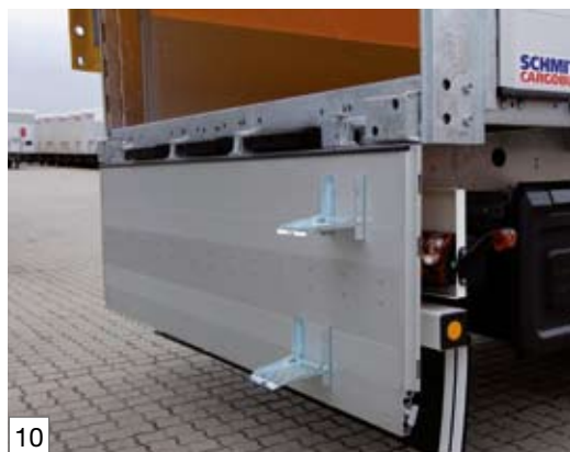
720mm hohe Alu-Rückwandklappe mit Zugankern auf den Scharnieren
