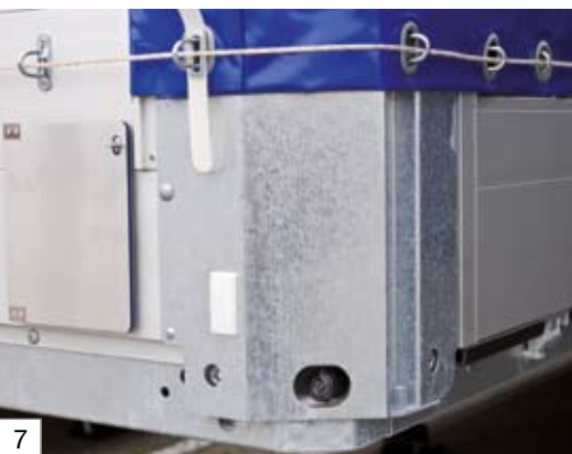
Verzinkte Stahl-Eckstützen für größere Festigkeit des Aufbaus
