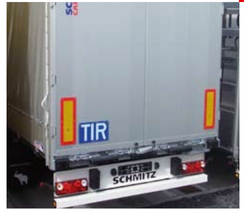
Rückwand mit Plane und hoher Rückwandtür zum schnellen, heckseitigen Be- und Entladen
