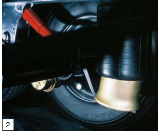
MRH-Luftfederung mit 350mm Ø Luftbalg und Stahlkolben
