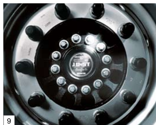
Hubodometer zur Kontrolle der Laufleistung
