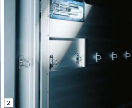
Bordwände 620/720mm mit robusten Spannverschlüssen
