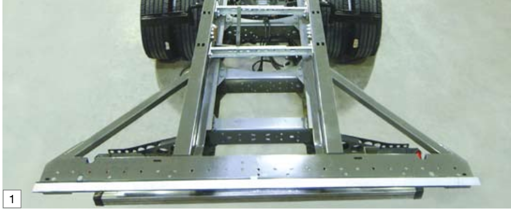
Robustes Chassis mit Diagonalstrebe hinten
