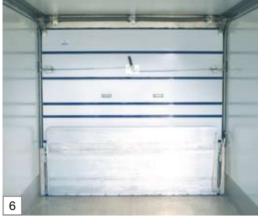
Aluboden, Stirnwall-Rolltor mit innenliegendem Überfahrblech
