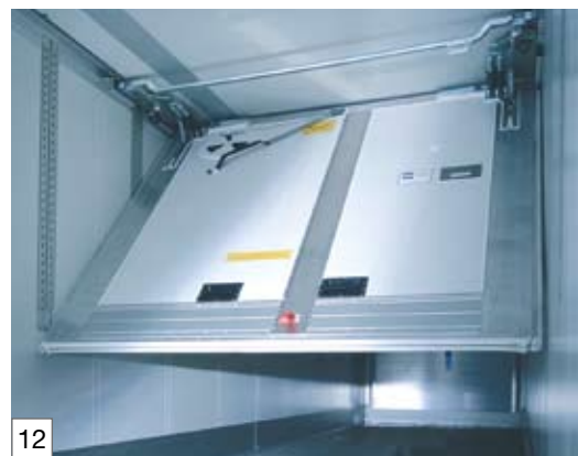
Längsverschiebbare, isolierte Quertrennwand
