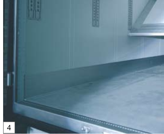
Bodentragfähigkeit 5,5t oder 7,1 t (Alu-Riffelblech Bodenwanne)
