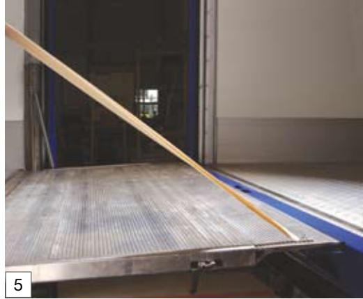
Die Verbindung von Motorwagen und Anhänger: Abweiser schützen die Seitenwände
