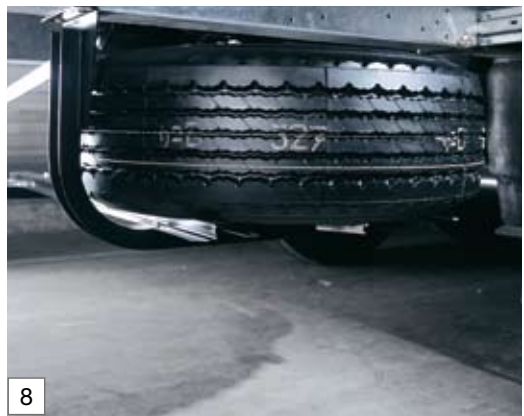
Radhalter für 2 Ersatzräder (hinten dem Fahrwerk)
