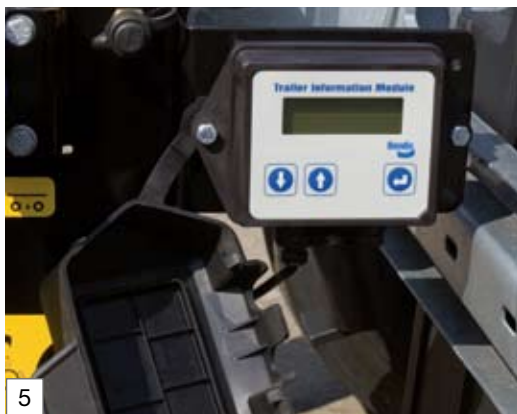
TIS (Trailer-Information-System) optional mit Bremsbelag-Verschleißanzeige, Hubodometer und/oder Achslast-Anzeige
