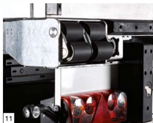
11 Kompressionsrollenrammpuffer zur effektiven Schock-Absorption bei Rampenkontakt
