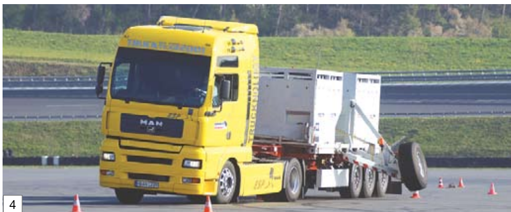
Sicher in jeder Lage. Das integrierte elektronische Stabilitätsprogramm RSP sorgt durch rechtzeitigen Bremsen- griff für eine sichere Kurvenlage auch in kritischen Situationen.
