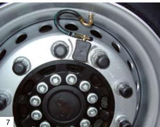
Reifendruck-Kontrollsystem erhöht die Laufleistung und reduziert Reifenschäden
