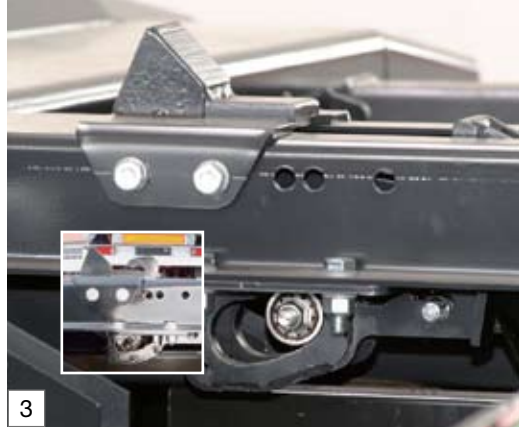
Die kulissegeführte 4-Punkt-Hakenverriegelung spannt den Container auf das Fahrgestell
