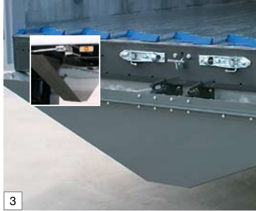
Am Heck ansteckbarer Getreidetrichter, Parkposition hinter dem Achsaggregat
