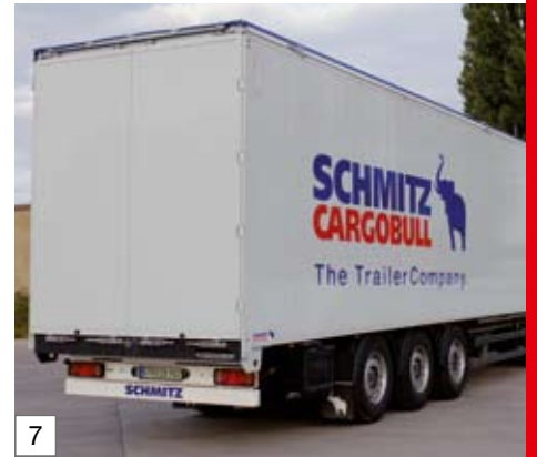
Aluminium-Portalrahmen, verstärkte Doppelflügeltür aus Aluminiumprofilen, 4 innenliegende Drehstangenverschlüsse, Spezialprofil mit doppelter Abdichtung
