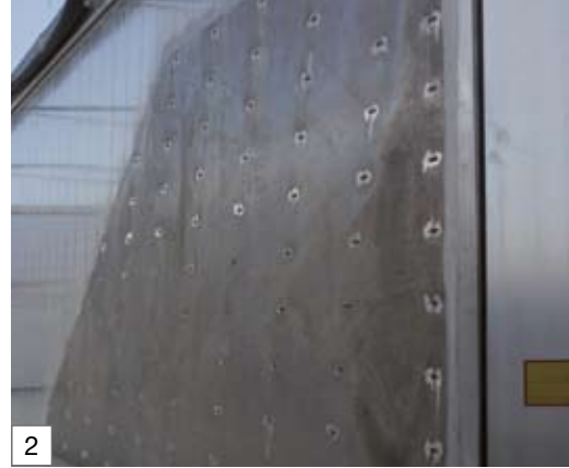
Aluminium-Verschleißbleche beidseitig im hinteren Bereich der Seitenwände
