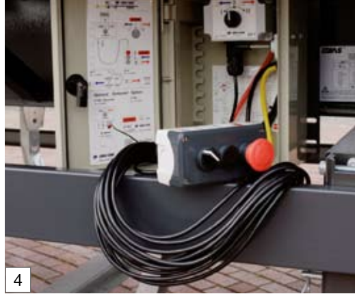
Bedieneinheit: CARGO FLOOR® System mit Fernbedienung
