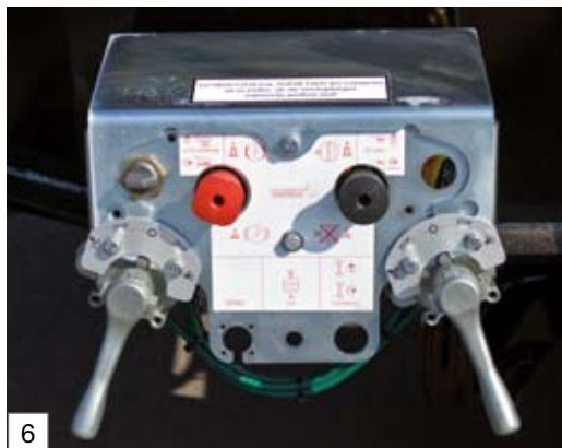
Bedieneinheit für Feststellbremse und Luftfederung mit zwei Hub- und Senkventilen sowie Container-Verriegelung
