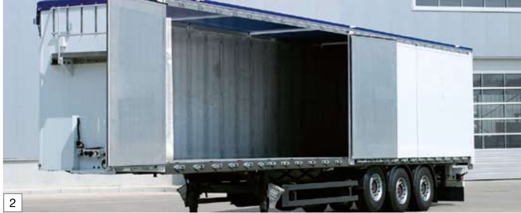
Aufbau mit 2 Seitentüren in Fahrrichtung links, Durchladebreite je 6.515 mm, Planenbefestigung in Fahrtrich- tung rechts. Option: 1 Seitentür
