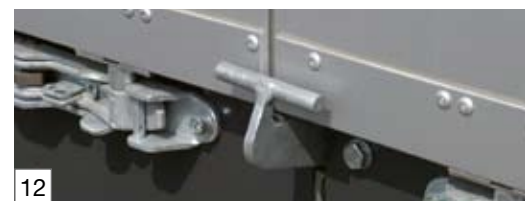
Pneumatische Sicherheitsverriegelung der Rück- wandtür, seitlich bedienbar
