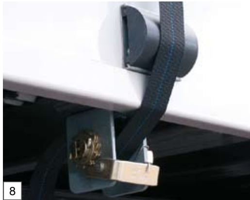
Planbefestigung mit Spanngurten und Ratschen
