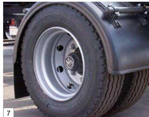
Wahlweise: Zwillings-Bereifung mit 10t Achsen
