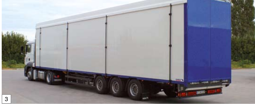
Volumen-Aufbau mit 98,4 m 3 Ladevolumen, Option: Volumen-Aufbau mit 100 m 3 Ladevolumen, Obergurt mit Delta-Leiste erhöht
