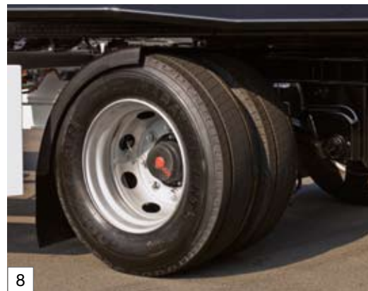
Premium Einfach-Bereifung fur 9t Achslast, Optional: Zwillingsbereifung fur 10t Achslast
