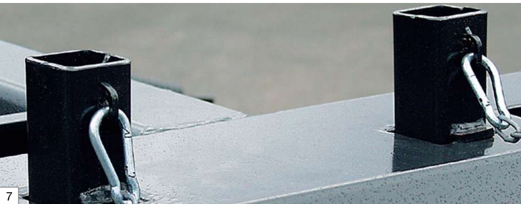
Steckanschage, vor und hinter der Containerrolle eingesteckt, sichern den Container zusatzlich
