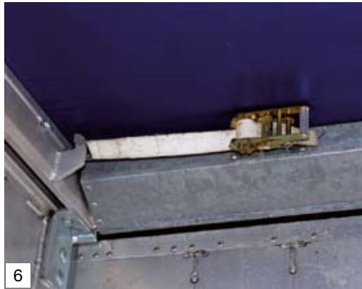
Schwenkbarer oberer Querbalken über der Rückwandtür mit Heranholfunktion durch Spanngurt und Ratsche
