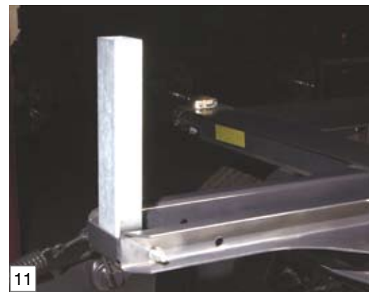
Klapp- und längenverstellbarer Anschlag für Wechselbrücken
