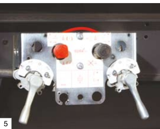
Bedieneinheit für Feststellbremse und Luftfederung mit zwei Hub- und Senkventilen seitlich am Langträger des A.WF
