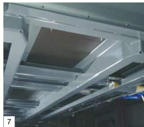
Stabile Bodenkonstruktion mit Zentriertunnel
