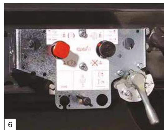
Bedieneinheit für Feststellbremse und Luftfederung mit einem Hub- und Senkventil seitlich am Langträger des Z.WF
