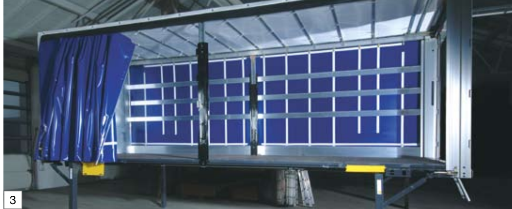
Seitliche Schiebepanele mit verschiebbarer Runge und Einstecklatten aus Aluminium
