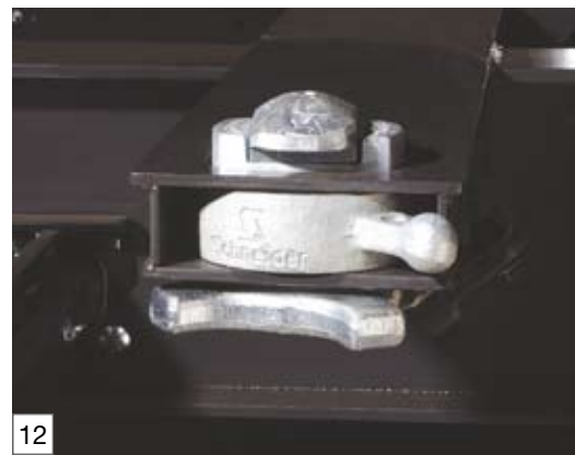
Verzinkte Containerverriegelung in absenkbarer Ausführung
