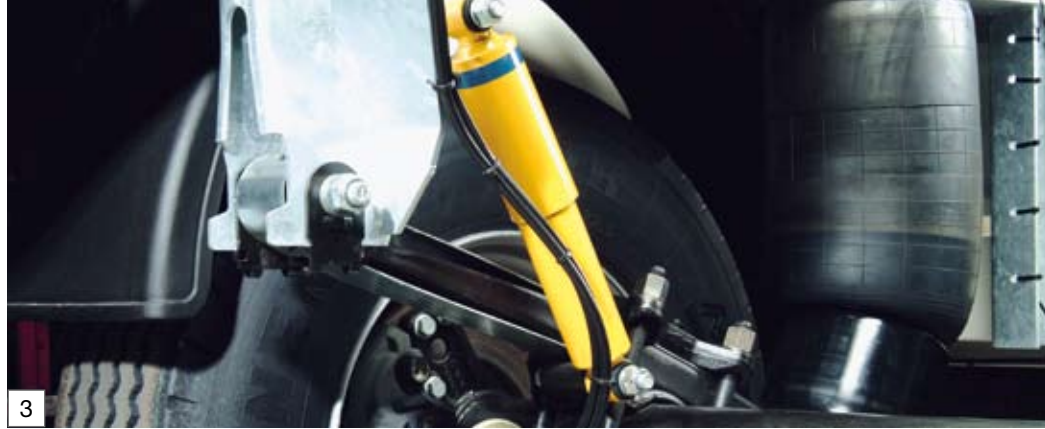
Schmitz Cargobull Luftfederung – ROTOS® Fahrwerk
