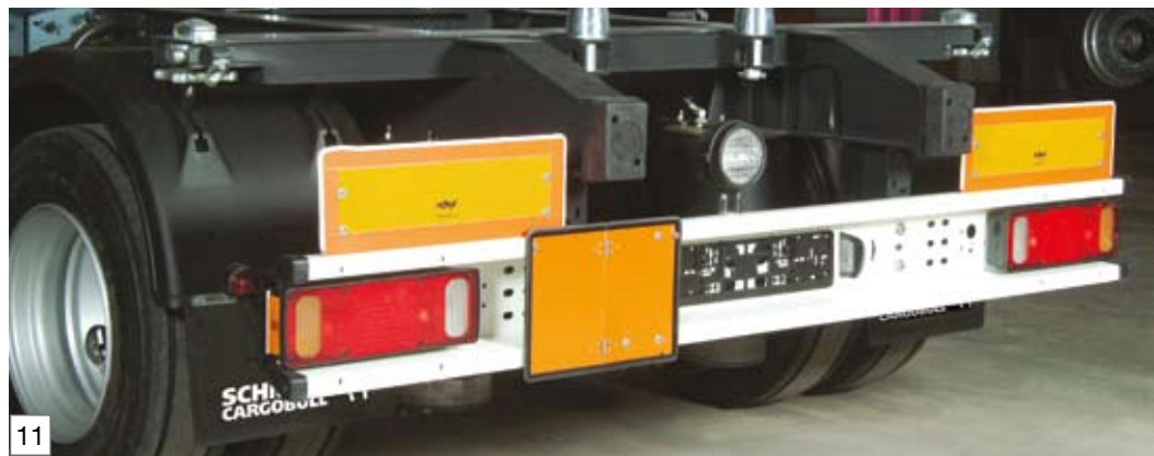
Heckabschluss mit weißem, pulverbeschichtetem Unterfahrschutz ohne CI-Blende, mit ECE-Warnmarkierungstafel, klappbarem GGVS-Schild und Arbeitsscheinwerfer
