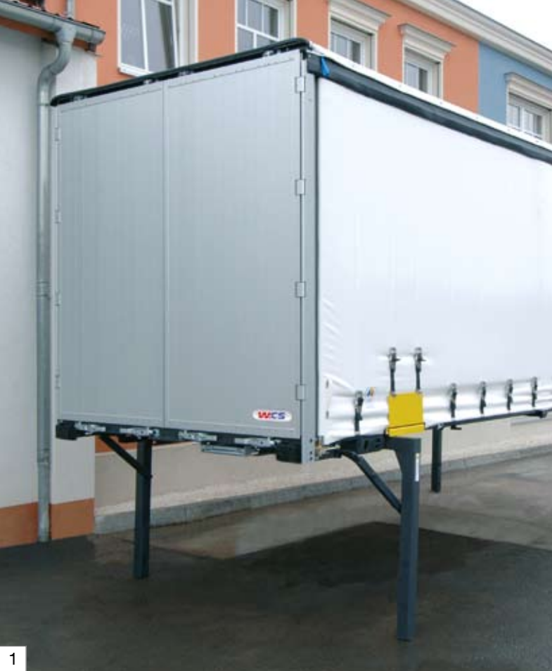
W.CS 7.45 Wechsel-Curtainsider in bahnverladbarer Ausführung
