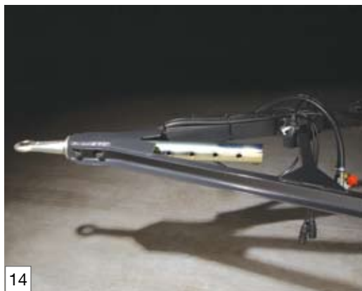
Längenverstellbare Zuggabel (6x100mm)
