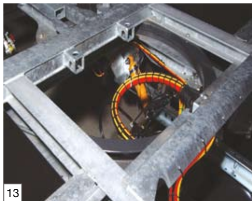
Drehgestell mit wartungsarmem Kugeldrehkranz
