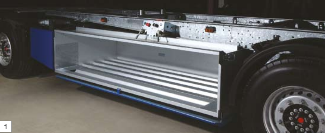
Verzinkter Palettenkasten in geschlossener Ausführung
