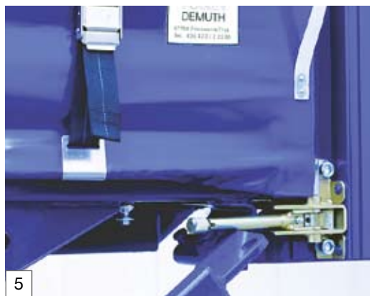
Planenspannung mit Ratschenspanngetriebe
