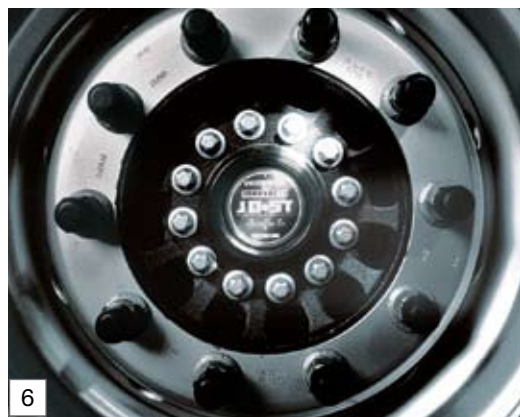
Hubodometer zur Kontrolle der Laufleistung
