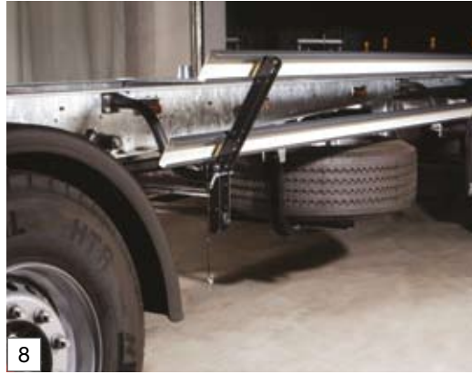
Doppelter Ersatzradhalter in Korbausführung und klappbare seitliche Schutteinrichtung
