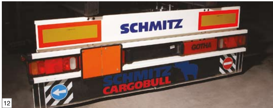
Heckabschluss mit weißem, pulverbeschichtetem Unterfahrschutz ohne CI-Blende, mit ECE-Warnmarkierungstafel, klappbarem GGVS-Schild und Spritzschutz über die gesamte Breite
