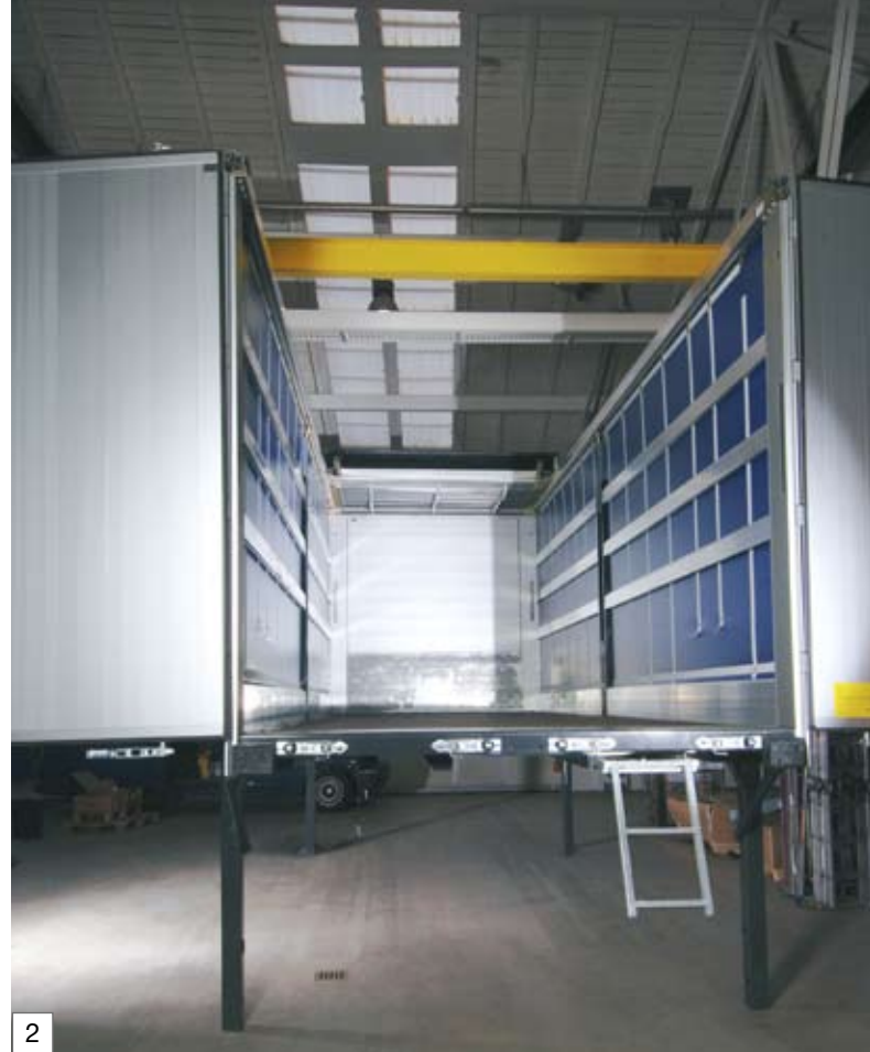
Schmitz Cargobull Schiebeverdeck, ausziehbare Aufstiegsleiter rechts am Heck
