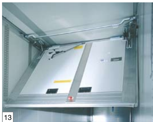
Längsverschiebbare, isolierte Quertrennwand
