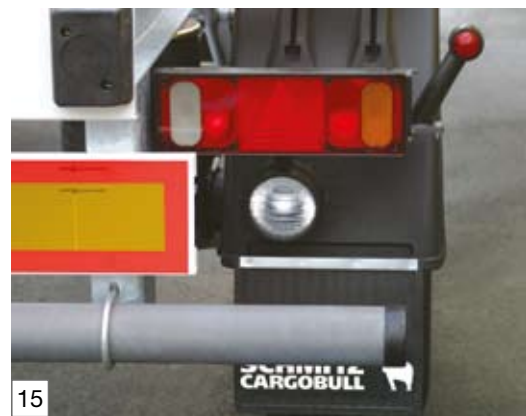
Arbeitsscheinwerfer; Stromversorgung über Rückfahrscheinwerfer, schaltbar am Arbeitsscheinwerfer
