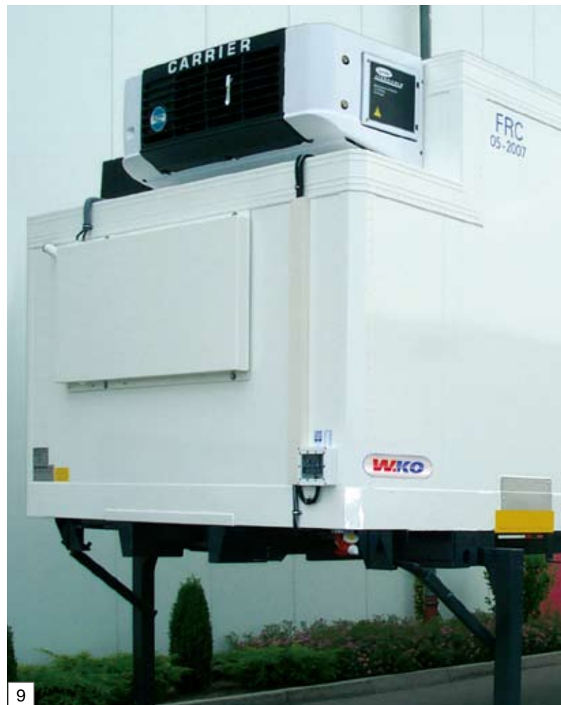
W.KO 7.45 FP 80/60 NB mit FERROPLAST® Aufbau, mit Kühlaggregat für Tiefkühltransporte
