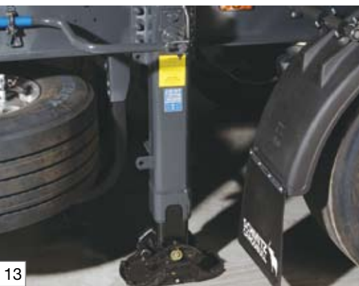
Zwei-Seiten-Stützwindwerk am Rahmen hinten, mit Einseitenbedienung rechts, Ausgleichfuß und zwei Getriebestufen
