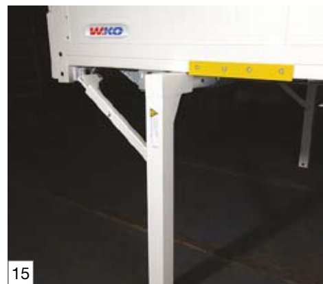
Stützbeine nach DIN EN 284, seitlich ausziehbar und um 90° in Längsrichtung klappbar
