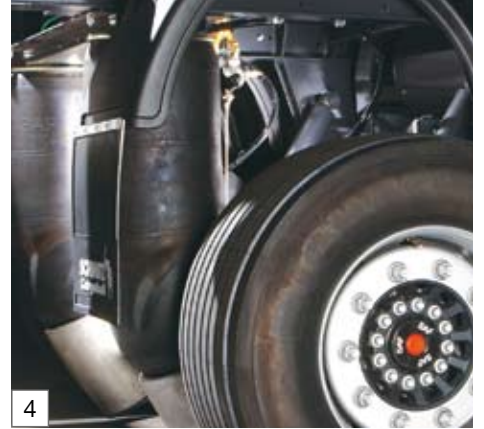
Luftfederung mit extra langem Hub
