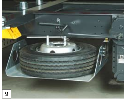
Einfacher Ersatzradhalter in Korbausführung für niedrige Bodenfreiheit
