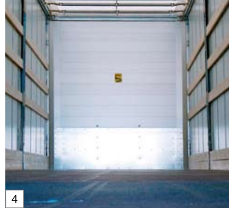
Stirnwand aus Aluminium-Hohlwand (eloxiert), mit Rammschutz aus 750mm hohem, verzinktem Stahlblech
