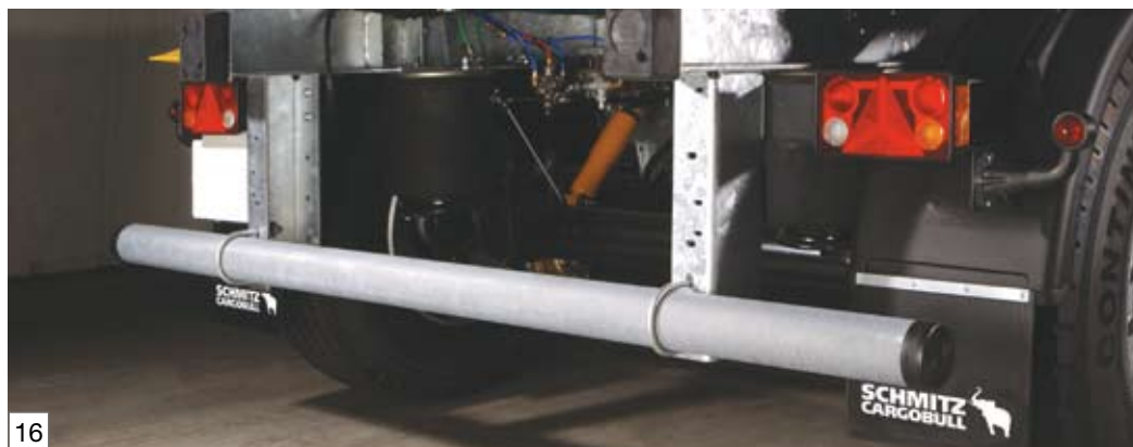
Verzinkter Unterfahrschutz als Rundrohr, geklemmt mit Mehrkammerschlussleuchten, Kennzeichenhalterung links
