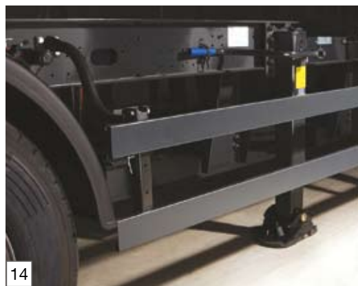
Zwei-Seiten-Stützwindwerk am Rahmen vorn, mit Einseitenbedienung rechts, Ausgleichfuß und zwei Getriebestufen
