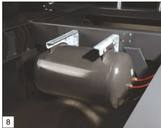
Zusätzlicher Luftvorratsbehälter mit 80 Liter Volumen
